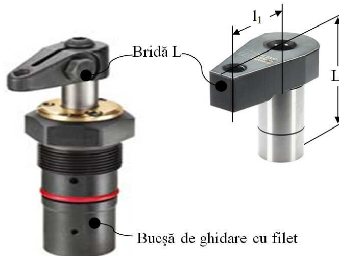
Fig. 5.44. Pârghie cu un braț – Bridă L – realizare industrială
