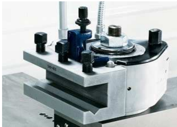
Fig. 5.37. Fixare directă cu șuruburi (ex.: portsculă pentru strunjit)
